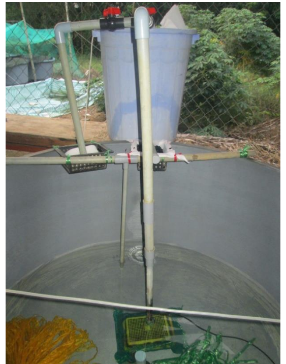
Hình 18: Hệ thống lọc
